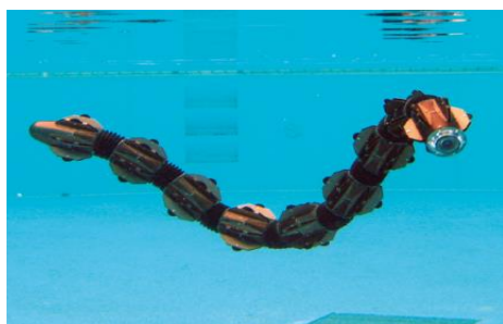
図1 水中を泳ぐウミヘビロボット[1]
