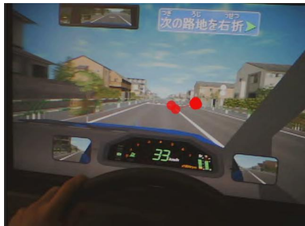
図 3 ドライビングシミュレータ画面と視線データ
